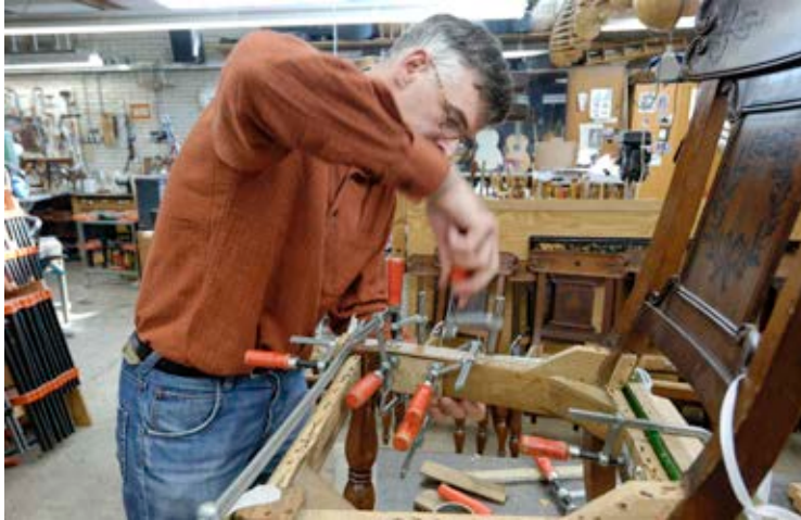
Afbeelding 17 Herstel van de aangetaste stoelrump door auteur.
