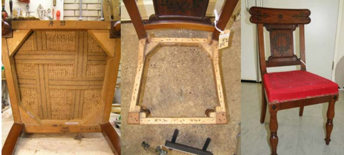
Afbeelding 14 De constructie van het zittingraam, de iepen kloesjes bij voorpoot en zijregel, het gemarketteerde rugpaneeltje.
